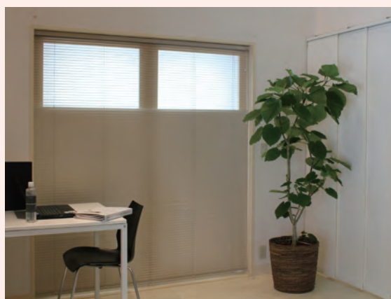
ブラインドの下部だけを閉じて、まぶしい直射光と外からの視線を遮り、上部から自然光を採り込む
